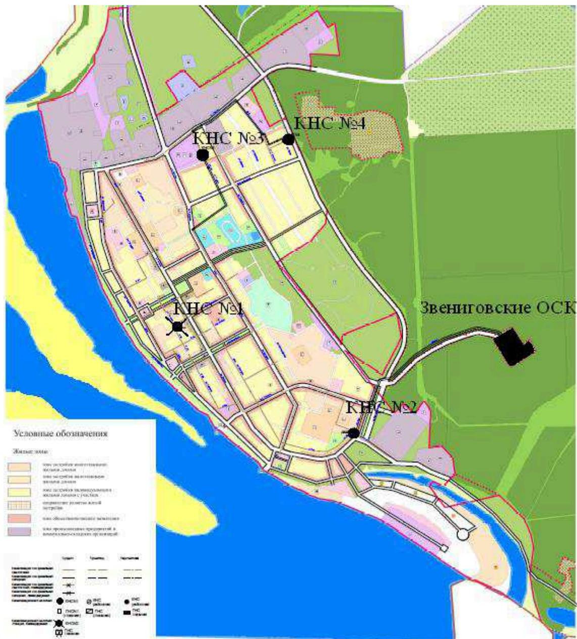
Рис.9.1.8. Фрагмент карты поселения с обозначенными на нем объектами централизованной системы водоотведения
